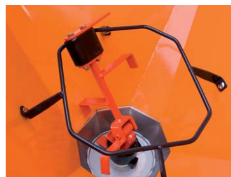
Mieszadło obraca się w pierścieniu chroniącym zbiornik.
