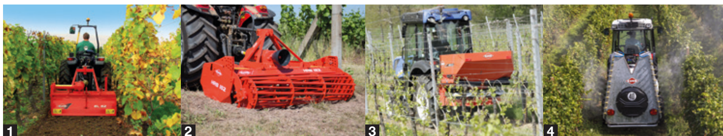
1. Glebogryzarki - 2. Brony wirnikowe - 3. Rozsiewacze nawozów - 4. Opryskiwacze
