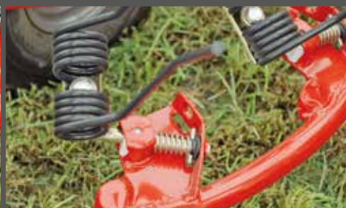
Przetrząsanie na obrzeżach pola – osłona pokosowa zapobiega stratom materiału.
