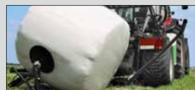
Stawiacz bel: odkłada bele płaską stroną na podłożu
