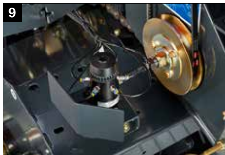
9 System ciągłego smarowania łańcucha BEKA MAX
