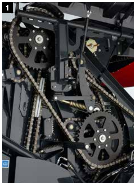
1 Wzmocniony układ napędowy z wytrzymałymi łańcuchami IWIS
