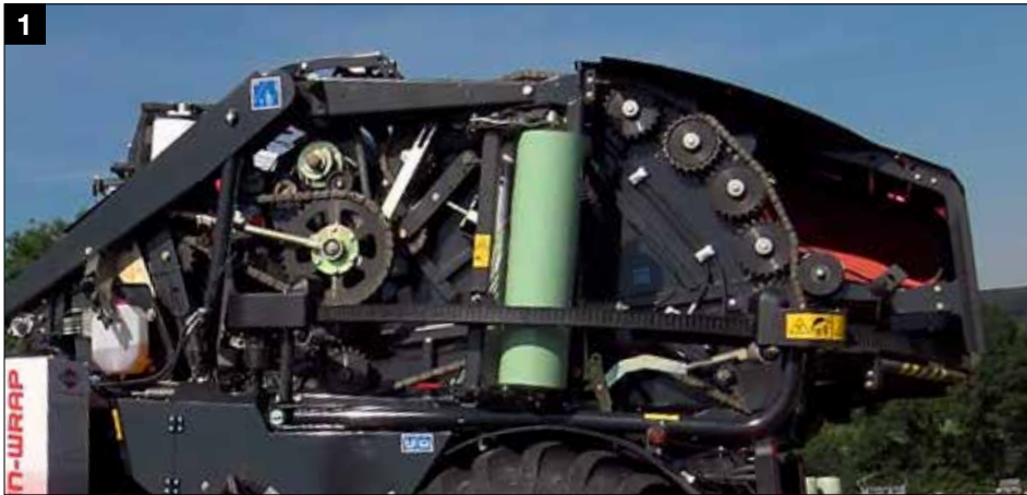
1 Wzmocniony układ napędowy z wytrzymałymi łańcuchami IWIS
