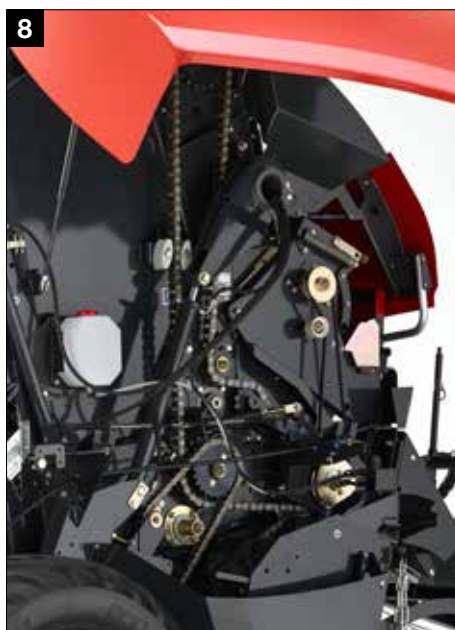
8 Wzmocniony układ napędowy z wytrzymałymi łańcuchami IWIS + wzmocniony główny napęd 1¼" 20BH z chromowanymi utwardzonymi sworzniami
