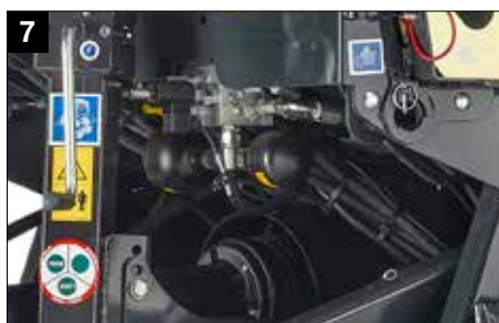
7 Zawór proporcjonalny regulujący zgniot belki z kabiny ciągnika
