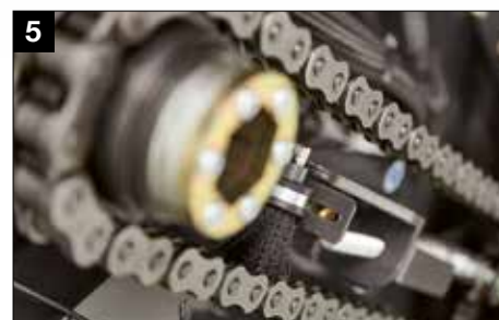
5 Solidne i szerokie szczotki olejowe na łańcuchach: doskonale smarowanie
