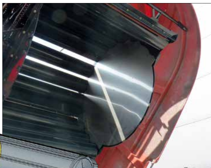
Płyty ze stali nierdzewnej o niskim współczynniku tarcia
