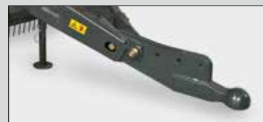
Kilka opcji zaczepu w tym zaczep kulowy
