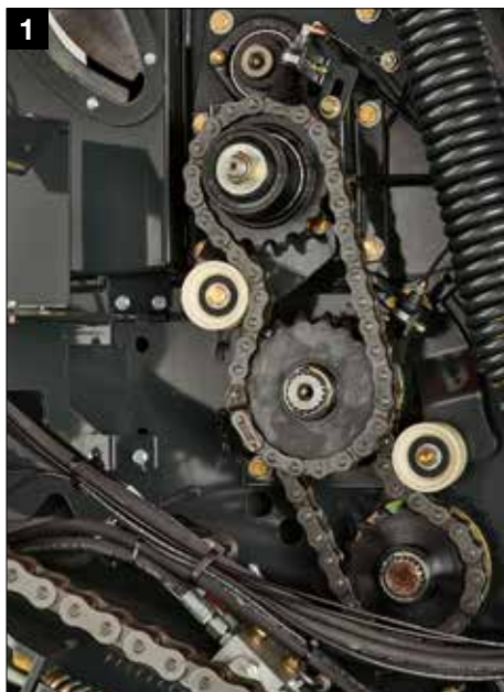
1 Druga rolka napędowa: gwarantuje prawidłowe prowadzenie pasa w każdych warunkach roboczych.
